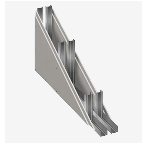
DOBBELTVEGGER (SD) To helt adskilte stenderverk med min. 10 mm avstand. To eller tre lag plater på begge sider. Alltid hulromsisolasjon.
