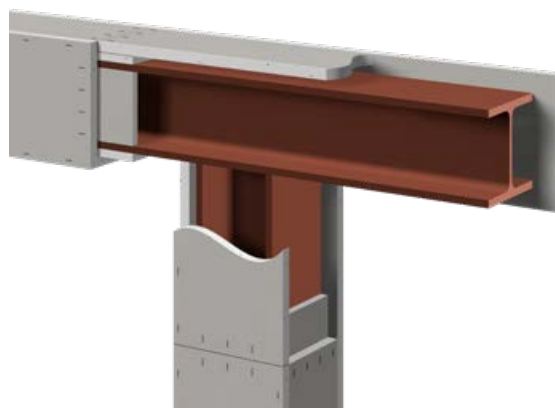
Bjelke kledt på 3 sider, understøttet av søyle kledt på 4 sider.
