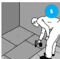
Skru platene direkte i underlaget. Ingen forboring er nødvendig. Anvend AQUAPANEL® Maxiskrue SN25. 9 skrueavstand minst 15 mm fra kanten.
